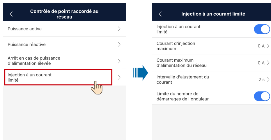
Figure 7-6 Injection à un courant limité
