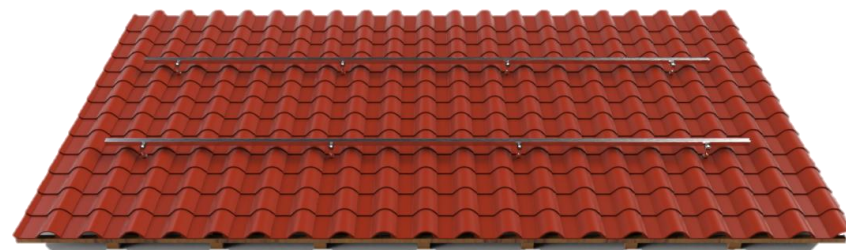
3.6 Installer le panneau solaire à l'extrémité du rail (laisser environ 600 mm de portée pour serrer la pince d'extrémité) 3.6 Installare i morsetti laterali, lasciare 600mm di spazio ai margini dei binari
